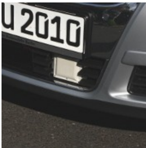
Slika 32: Radar za prepreke
