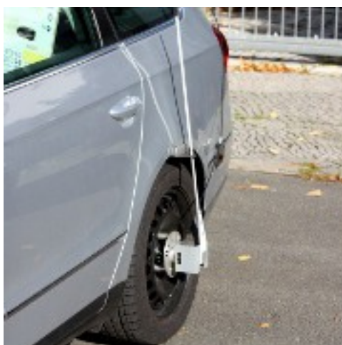
Slika 28: Odometar prikačen na točak
