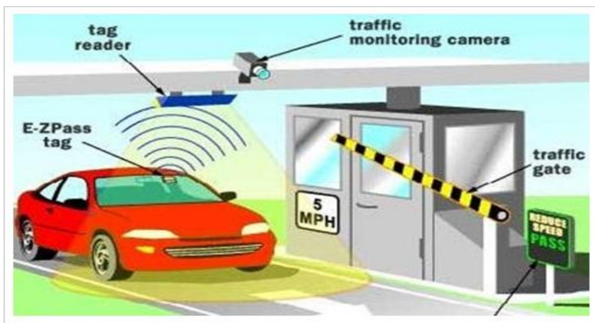
Слика 18. Наплата путарине коришћењем RFID технологије
